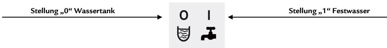
**Gerät im Betrieb mit Festwasseranschluss**
