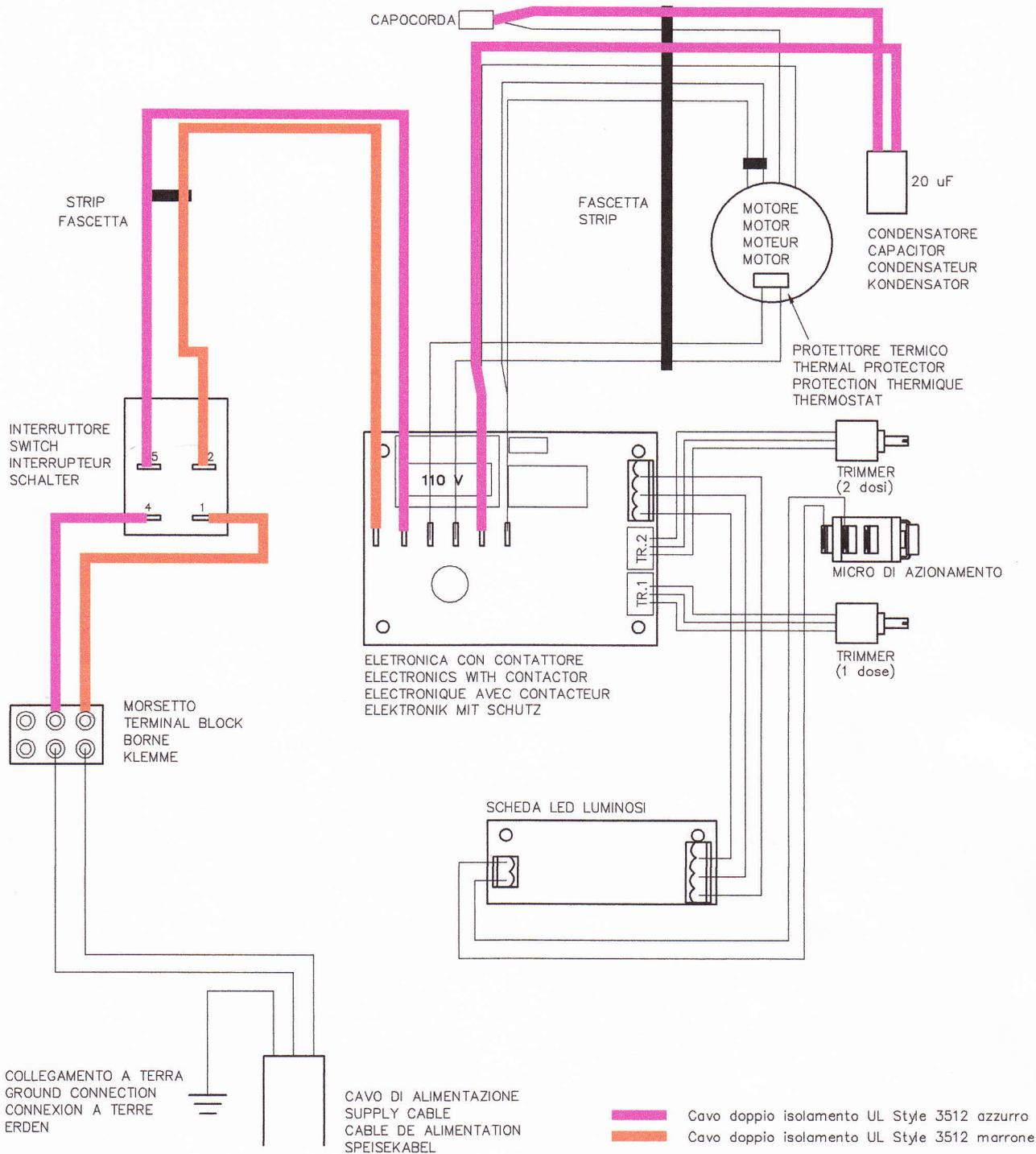
N.B.: Tutti gli altri cavi dell'impianto elettrico devono essere rivestiti con guaina a 2500V/min
